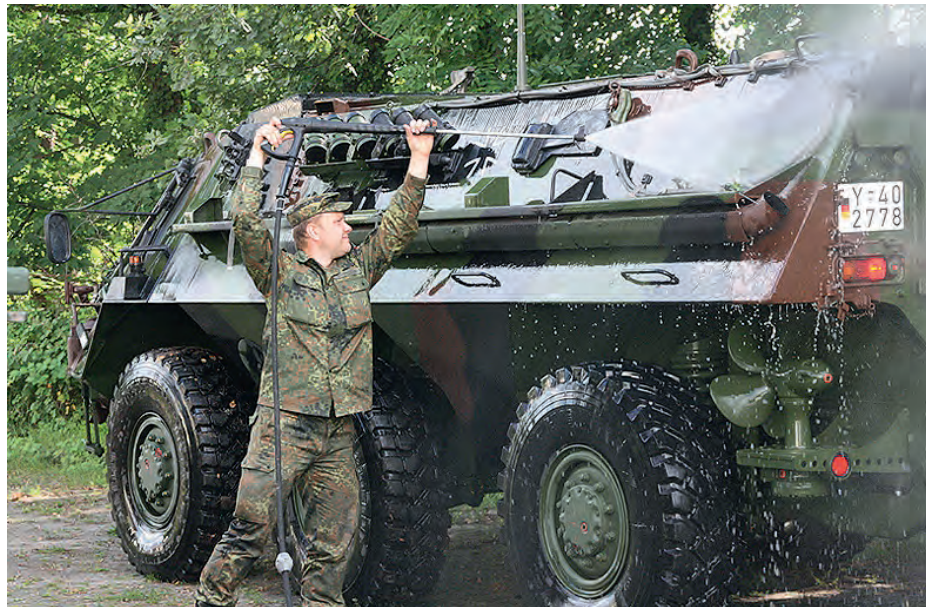
Mit scharfem Wasserstrahl spritzt der Soldat in die kleinsten Ritzen des Panzerfahrzeugs, um alle eventuellen Giftstoffe abzuspielen
