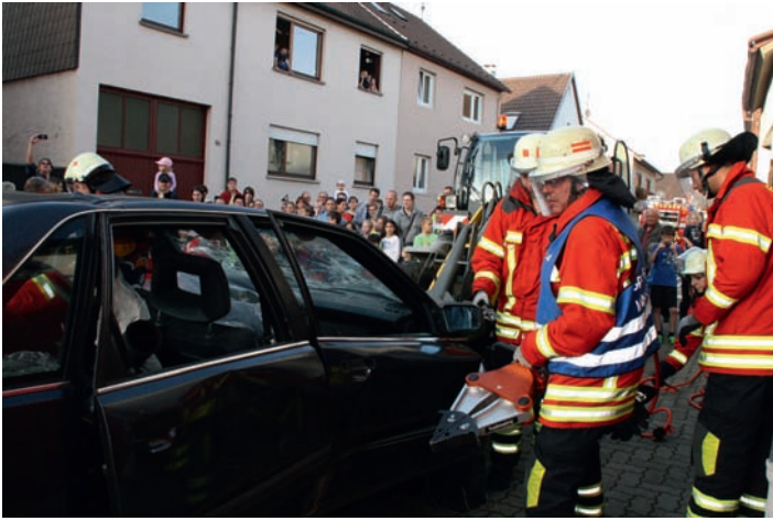
Bei den Einsätzen der Feuerwehr ist häufig schweres technisches Gerät erforderlich, wie hier der Hydraulische Spreizer.
