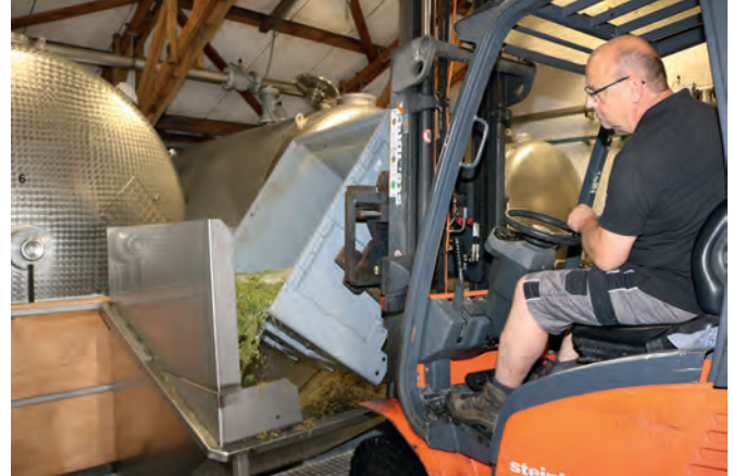
Frank Gauss kippt mit Stapler den Beerenbrei aus den Bottichen in die Presse
