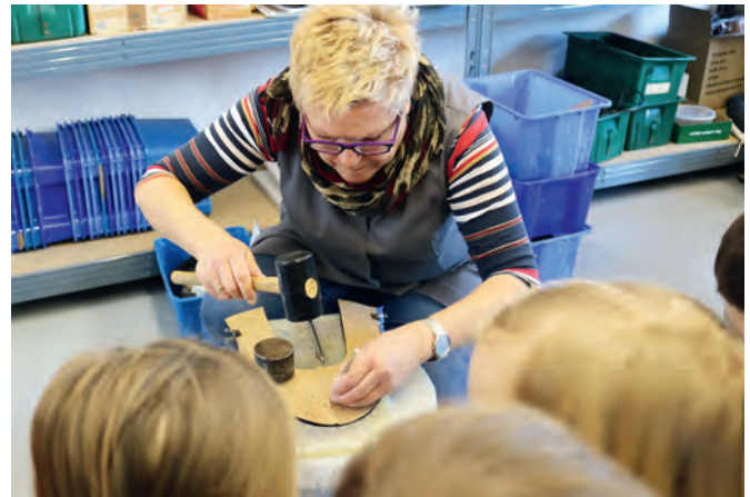
Kleine Löcher verzieren die Kappe eines wertvollen Schuhs. Veronika Mehl stanzt sie mit einer Ahle in das Leder.
