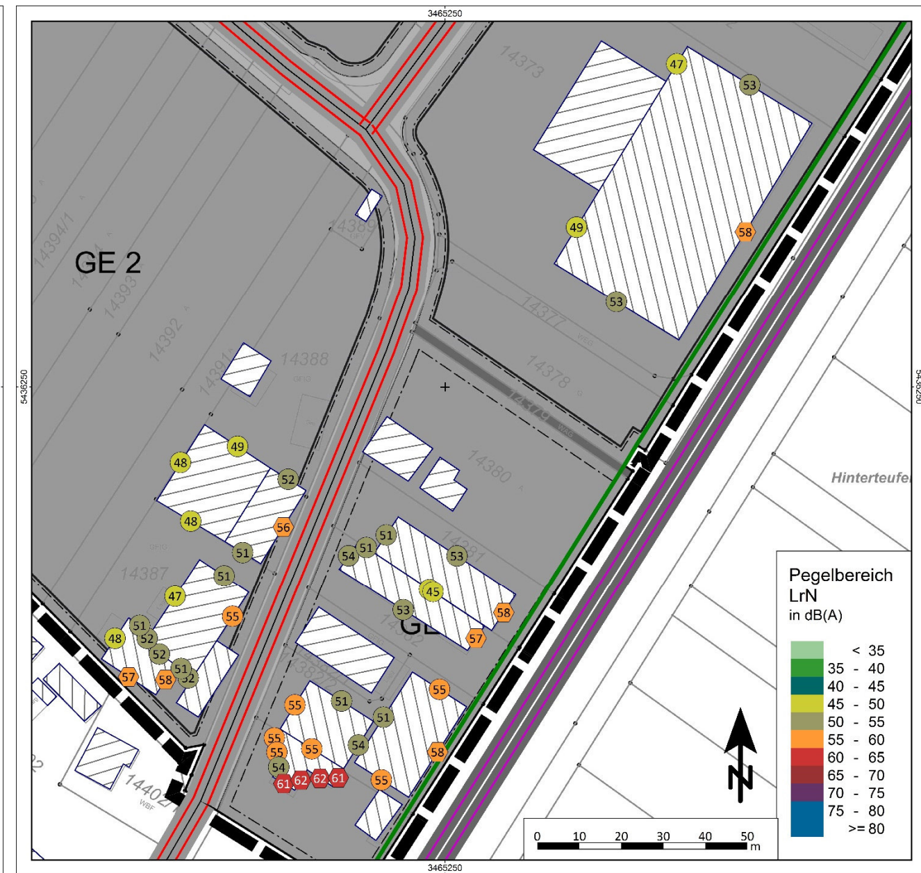
Abbildung 20: Beurteilungspegel des gesamten Straßen- und Schienenverkehrslärms mit Lärmschutzwand im jeweils am stärksten betroffenen Geschoss der im Plangebiet bereits vorhandenen Gebäude im Nachtzeitraum (22:00 bis 06:00 Uhr); Beurteilungsgrundlage: DIN 18005-1
