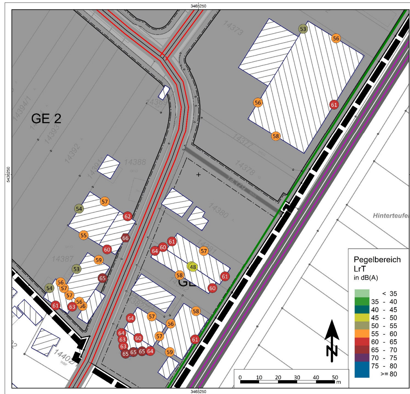
Abbildung 19: Beurteilungspegel des gesamten Straßen- und Schienenverkehrslärms mit Lärmschutzwand im jeweils am stärksten betroffenen Geschoss der im Plangebiet bereits vorhandenen Gebäude im Tagzeitraum (06:00 bis 22:00 Uhr); Beurteilungsgrundlage: DIN 18005-1
