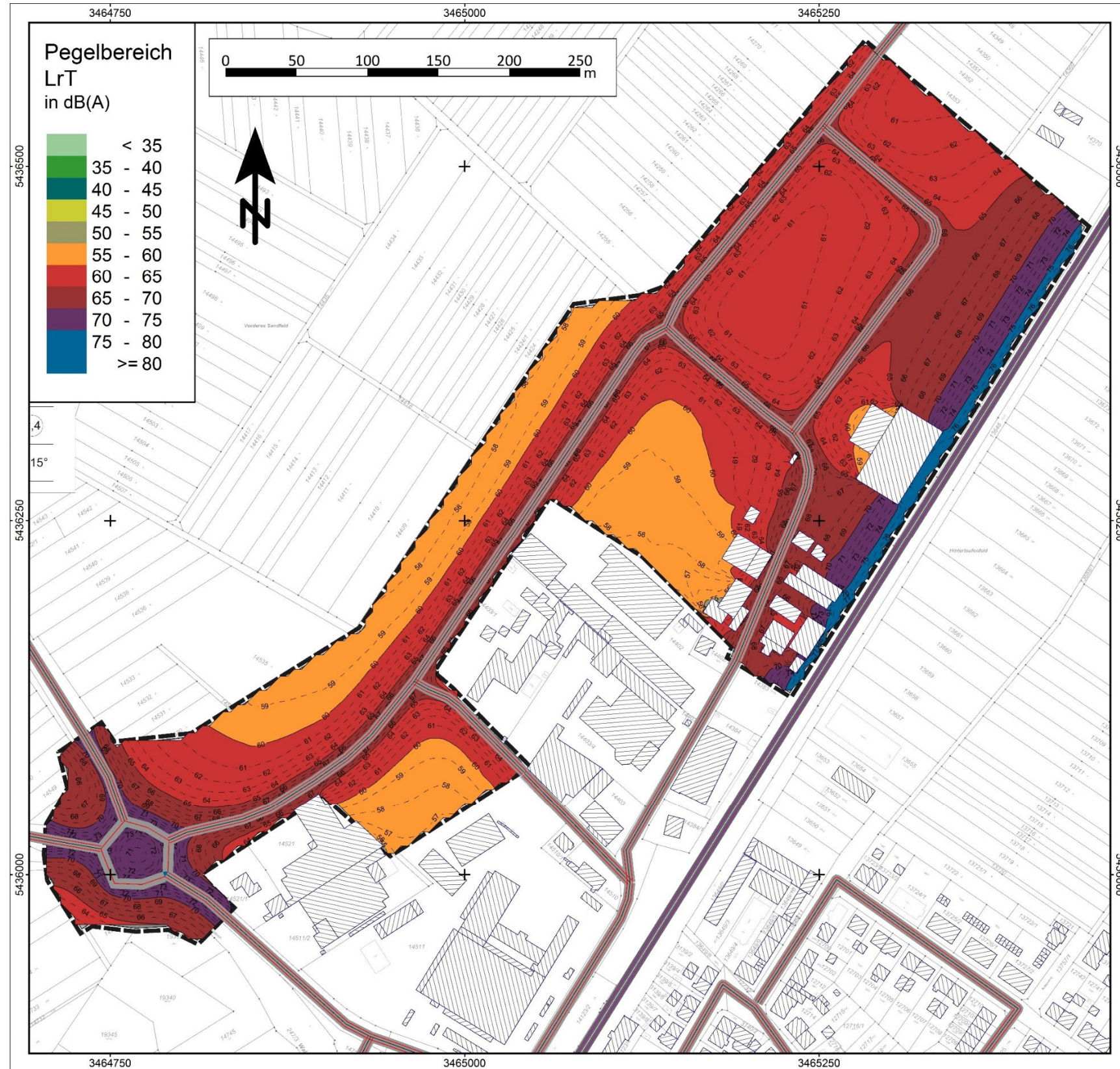
Abbildung 6: Rasterlärmkarte der Beurteilungspegel des gesamten Verkehrslärms innerhalb des Plangebiets im Tagzeitraum (06:00 bis 22:00 Uhr) in einer Berechnungshöhe von 3,5 m über Grund (Erdgeschoss)
