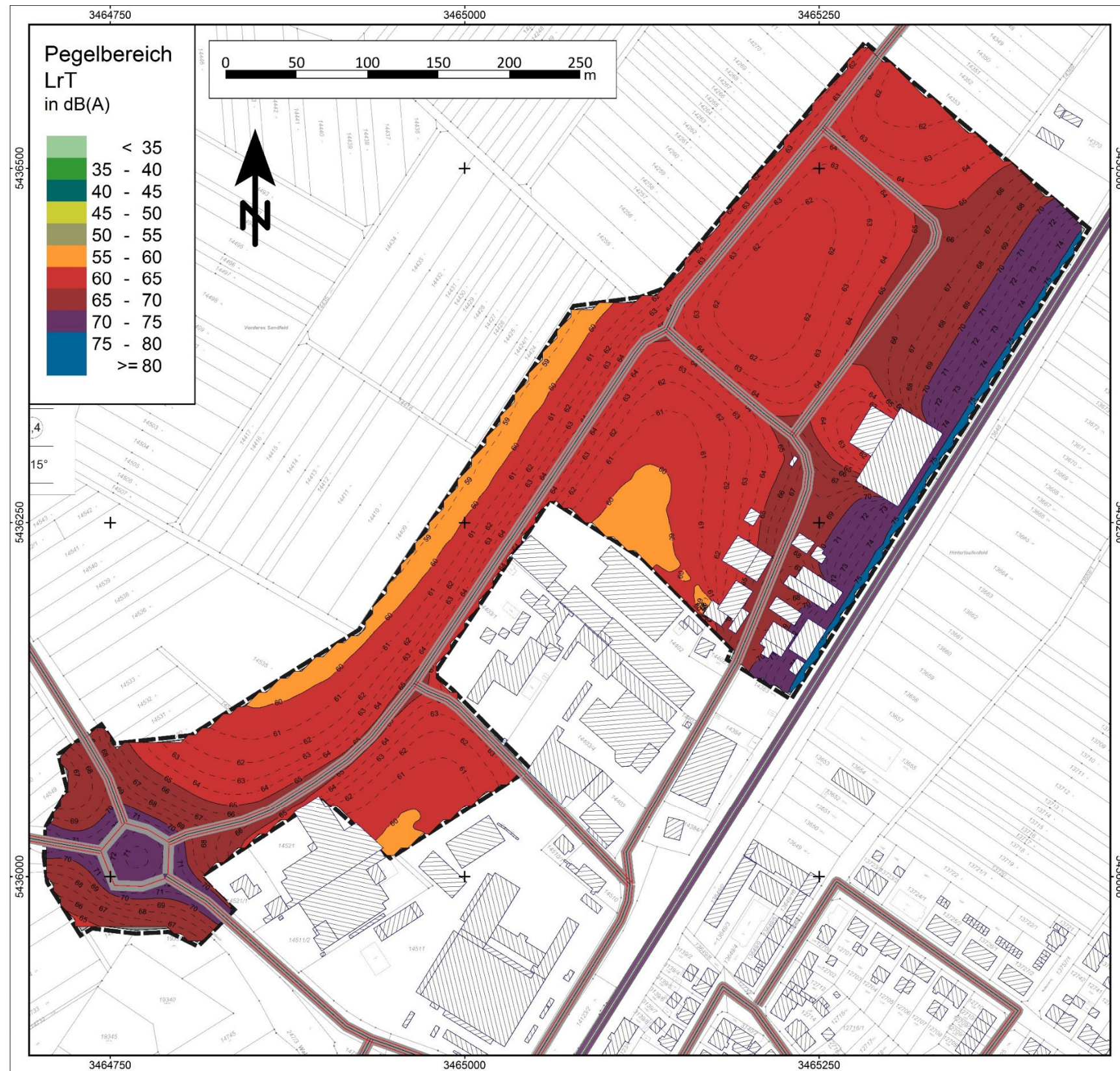
Abbildung 8: Rasterlärmkarte der Beurteilungspegel des gesamten Verkehrslärms innerhalb des Plangebiets im Tagzeitraum (06:00 bis 22:00 Uhr) in einer Berechnungshöhe von 9,1 m über Grund (2. Obergeschoss)
