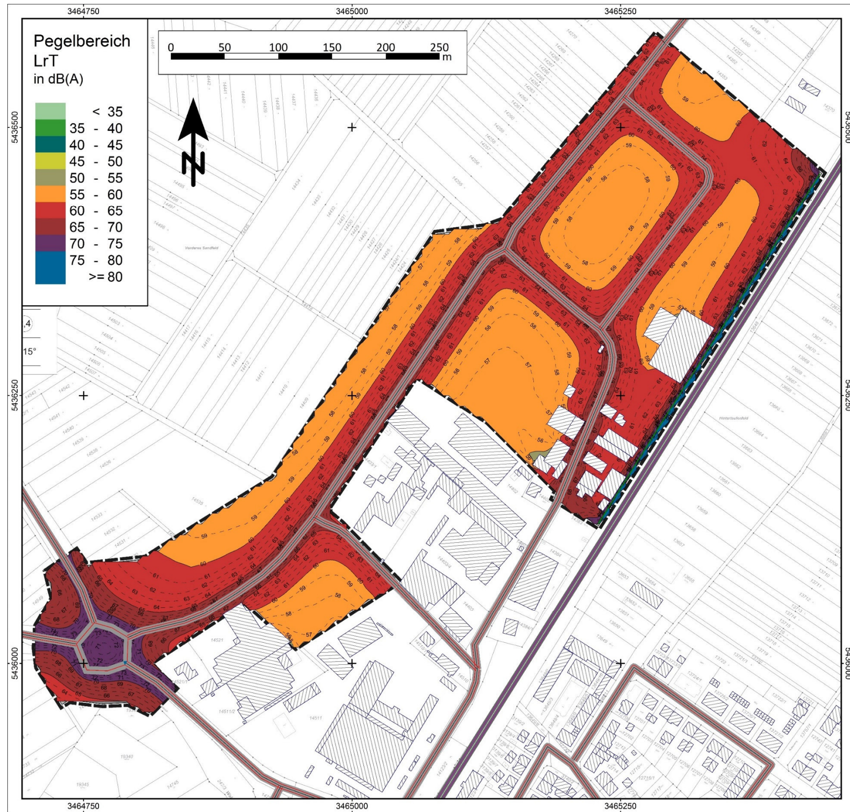
Abbildung 22: Rasterlärmkarte der Beurteilungspegel des gesamten Verkehrslärms innerhalb des Plangebiets im Tagzeitraum (06:00 bis 22:00 Uhr) in einer Berechnungshöhe von 3,5 m über Grund (Erdgeschoss)
